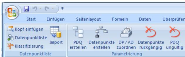
Mit dem **Importmodul** erfolgt die Erfassung von offline in Dateien oder Datenbanken vorliegenden Daten. Mittels unterschiedlicher Importfilter werden z.Z. über 75 unterschiedliche Dateiformate und Datenbanksysteme unterstützt (TXT, CSV, XML, ODBC, ADO, ORACLE, MDB, XLS, XLSM, Logger, usw). Neue Importfilter können unkompliziert und kostengünstig nach Kundenanforderung erstellt werden. Schon heute ist das Pflichtformat der Energiewirtschaft
